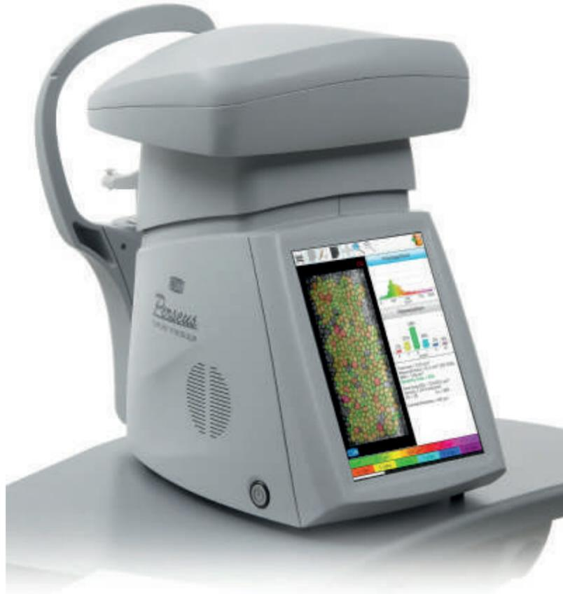
La densità cellulare, i valori di Pleomorfismo e Polimegatismo, unitamente al dato pachimetrico vengono calcolati automaticamente. Qualora si renda necessario effettuare valutazioni su zone periferiche della cornea il dispositivo è dotato di mire di fissazione atte allo scopo.
